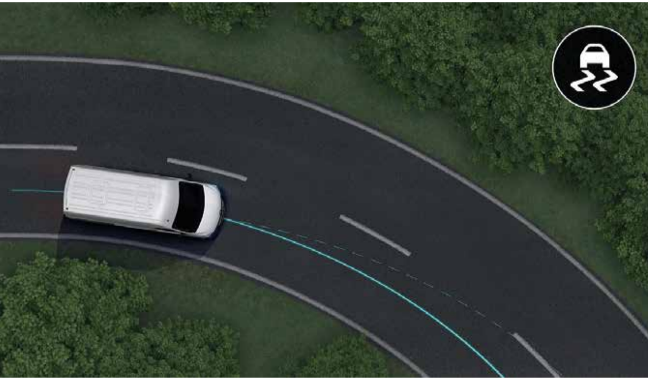
sistema de control de estabilidad (ESP) El ESP permite corregir la trayectoria del vehículo para evitar deslizamientos.
