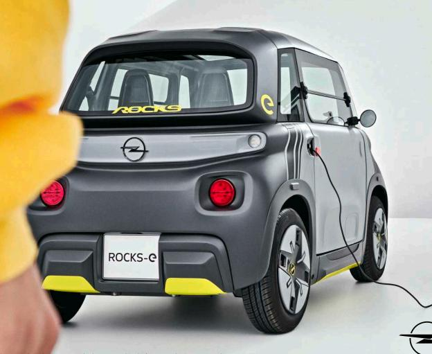
\*Tiempos de carga en tomacorriente domestico (8h - 110V / 4h - 220V). El tiempo de carga varía según la temperatura de la batería, la edad de la batería, los ciclos de carga y descarga.
